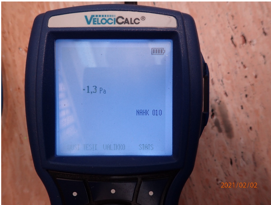
Kuva 3, Paine-ero alapohjan eristetilan ja sisäilman välillä.
