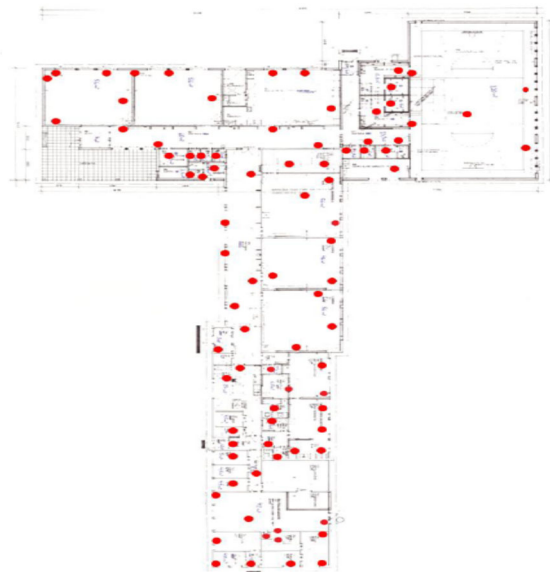
Kuva 7. Homekoiran merkkaukset rakennuksessa
